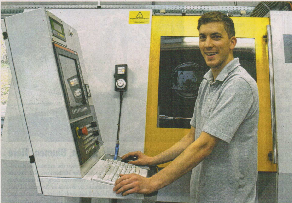
Max Probst bei der Arbeit an einer Rundsleifmaschine. Hier kann man Werkzeuge auf Durchmesser schleifen. Foto: Elisa Hipp
